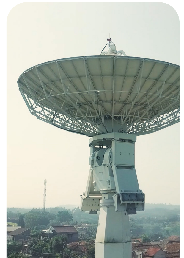
Kawasan Stasiun Lapangan (KSL) Stasiun Bumi BRIN Biak yang berfungsi untuk melaksanakan penerimaan data dan kendali satelit, observasi antariksa dan atmosfer. © BKPUK BRIN
