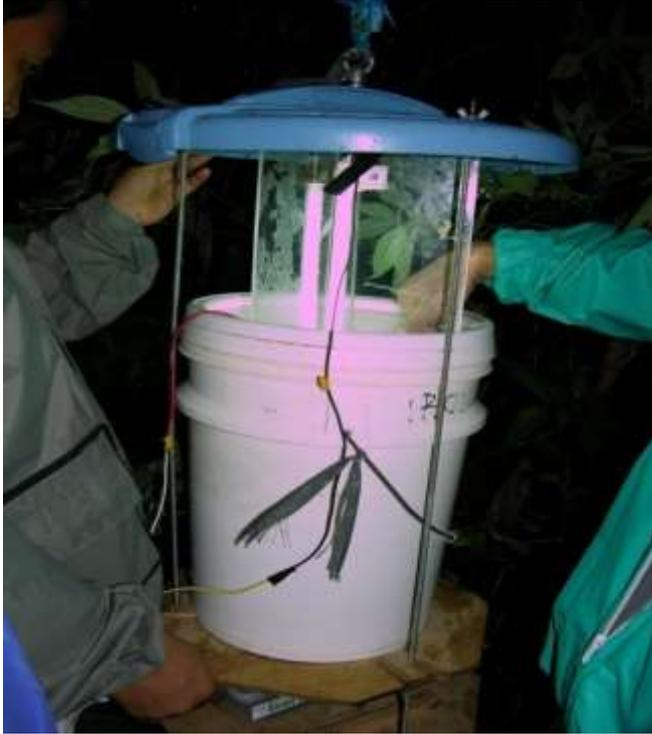
**Gambar 2.4.** Perangkap lampu atau light trap
