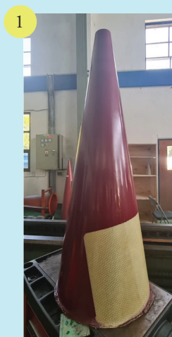
Gambar 3.30 Prototipe Nosecone RHAN 450 yang terbuat dari material composites dengan nosetip yang terbuat dari baja
