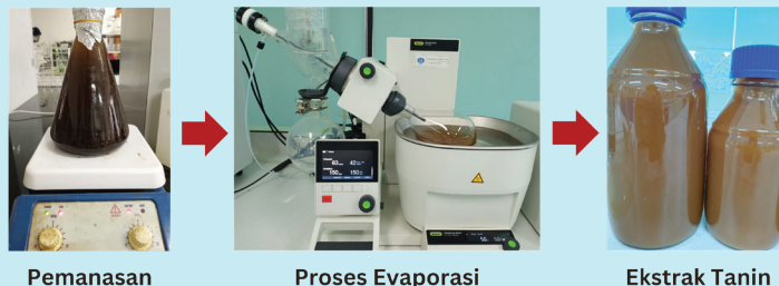
Gambar 3.23 Proses ekstraksi tanin dari kulit kayu mangium
