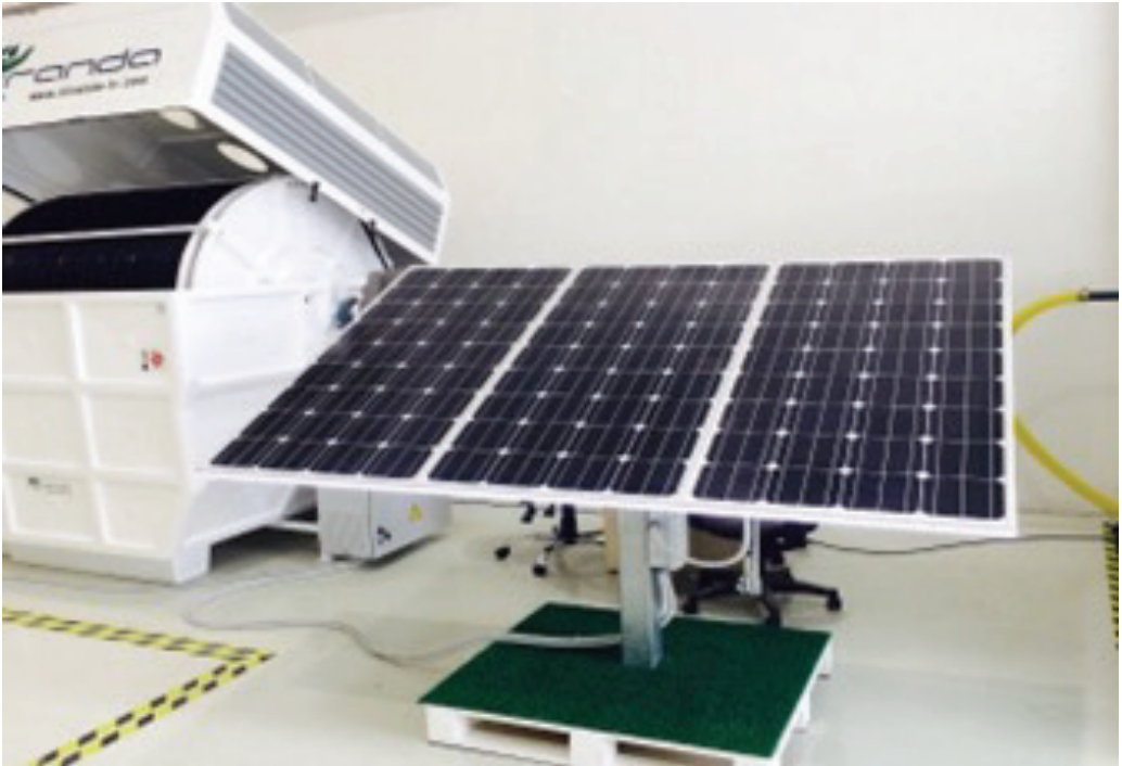
Gambar 5.7 Panel Surya untuk Pengolahan Air Limbah
