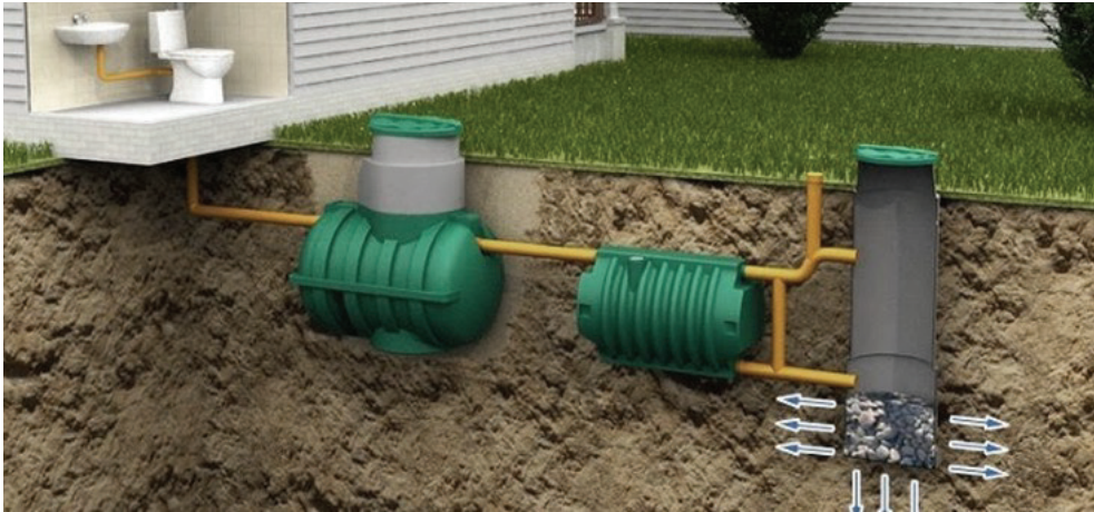
Gambar 1.2 Ilustrasi Sistem Pengolahan Air Limbah Setempat
