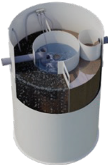
Gambar 3.4 Tangki dengan kompartemen radial dan konsentrik
