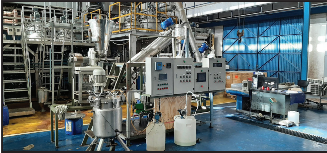
(a) Screw continuous reactor untuk pretreatment biomassa lignoselulosa secara kontinu
