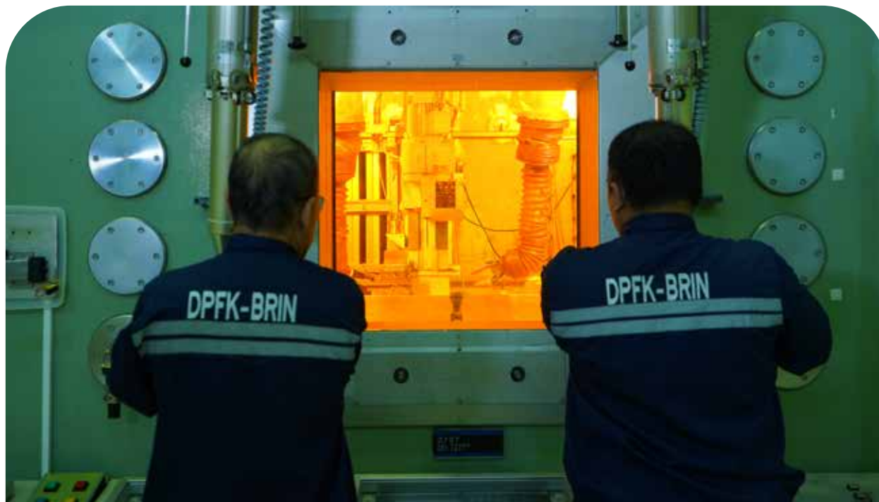
Petugas dari Direktorat Pengelolaan Fasilitas Ketenaganukliran (DPFK) BRIN mengambil target iradiasi di Hot Cell - Reaktor Nuklir Serbaguna G.A. Siwabessy untuk mendukung kemandirian produksi radiofarmaka Indonesia. Foto © BKPUK
