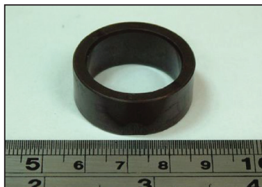
Gambar 4.5 Purwarupa Magnet Barium Stronsium Ferit untuk Motor DC
