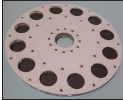
Gambar 4.7 Rotor Menggunakan Magnet Bonded NdFeB
