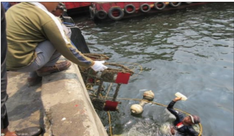
Gambar 3.7 Pemasangan sampel cat SPC-AF di pelabuhan Muara Baru, Jakarta
