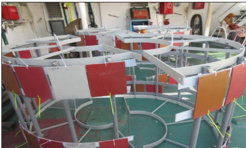
Gambar 3.4 Rak uji cat antifouling di daerah mandara Bali
