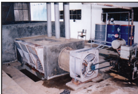
Gambar 3.6 Pengering tipe bak bahan bakar sekam
