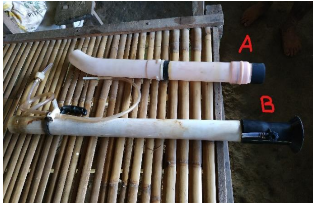
Gambar 9.5 Pipa Penyemprot yang Digunakan Untuk Tanam Benih Langsung dan Pemupukan
