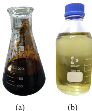
Gambar 3.7 Foto bio-oil yang berasal dari ko-pirolisis pelepah kelapa sawit dan polistiren (a) serta produk hasil distilasi (b)
