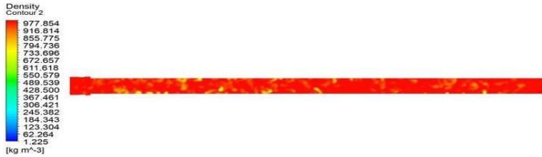
Gambar 3.4 Kontur densitas pada penampang ultrasonik dengan frekuensi 20 kHz.
