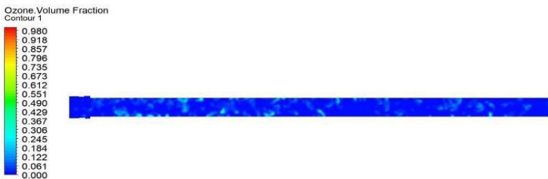
Gambar 3.3 Fraksi volume ozon pada penampang ultrasonik dengan frekuensi 20 kHz.
