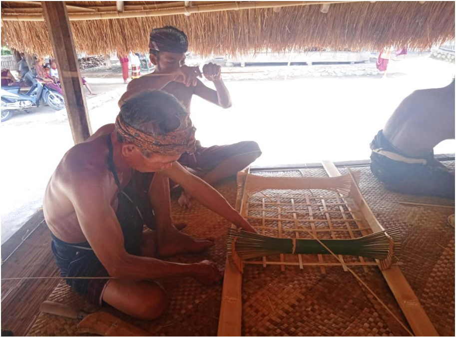
Gambar 157 | Pemasangan rancak dan apitan di atas tandu (Foto: Suliadi)
