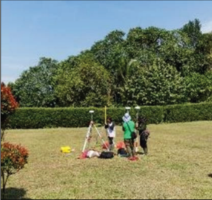
Gambar 4.2 Pengukuran topografi lahan menggunakan GPS RT area riset Yogyakarta tahun 2020.
