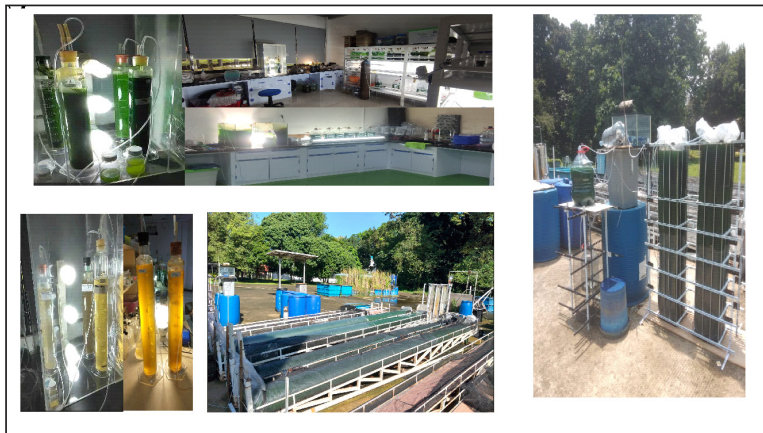
Gambar 9. Varian fotobioreaktor bench top volume kerja 2-3 L: Bubble column reactor untuk dua mikroalga hijau Scenedesmus dimorphus dan Chlorella pyrenoidosa (a), bench top system untuk proliferasi diatom Thalassiosera weissflogii (b), scaling up pada system inclined outdoor dengan volume kerja 450 L (c), dan scaling up pada sistem vertical outdoor PBR dengan volume kerja 250 L (d) (Awalina et al., 2024a; 2025a).
