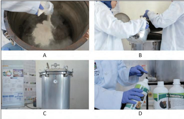
Keterangan: Pembuatan medium optimasi pada fermentor (A), Pemindahan starter probiotik ke dalam fermentor (B), Inkubasi probiotik dalam fermentor (18 jam pada suhu ruang) (C), Pengemasan probiotik dalam kemasan botol 1 L (D)
