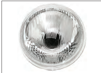
Gambar 2.12 Lensa lampu utama mobil dilengkapi lensa seperti sarang lebah.
