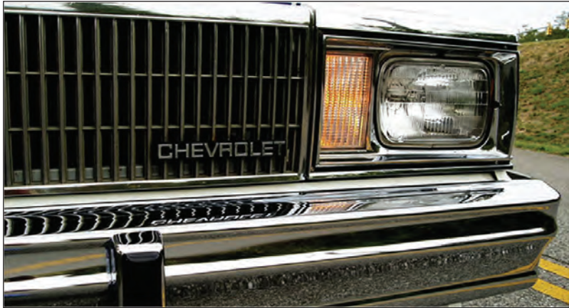
Gambar 2.6 Model Lampu Utama Jauh dan Lampu Utama Dekat Menyatu
