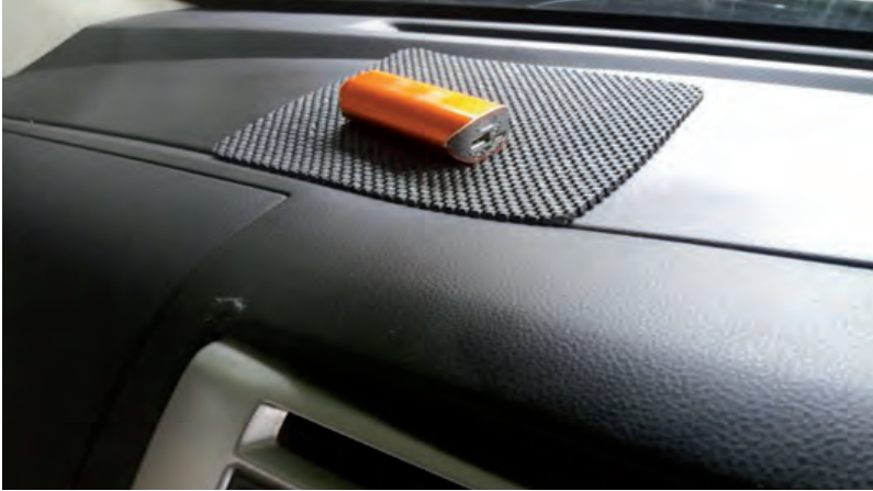
Gambar 1.16 Dash-mat yang berfungsi sebagai perangkap cahaya ( light absorbing ) di samping fungsi lain agar benda-benda yang berada di atasnya tidak tergelincir saat kendaraan bermanuver.
