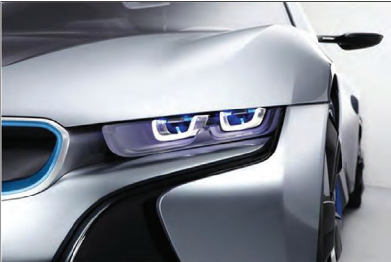
Gambar 3.2 Lampu Utama Laser Mobil BMW i8
