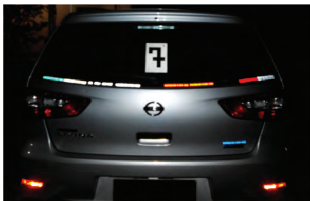
Gambar 3.34 Penampilan Marka Opto Elektronik Penanda Jarak Aman
