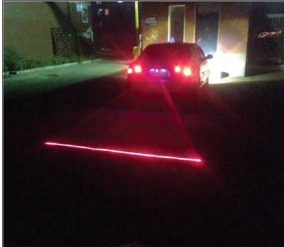
Gambar 3.18 Pola Garis Laser Penembus Kabut untuk Mencegah Tabrak Belakang Akibat Cuaca Buruk
