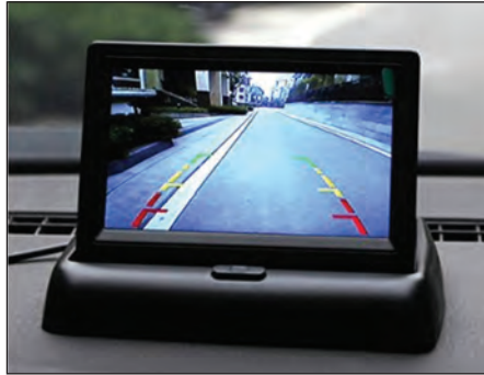
Gambar 3.9 Monitor televisi memperlihatkan bagian belakang kendaraan saat posisi mundur.
