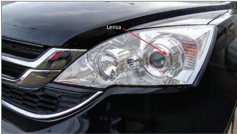
Gambar 2.15 Salah satu wujud lampu utama kendaraan dengan memanfaatkan lensa pada Gambar 2.14.
