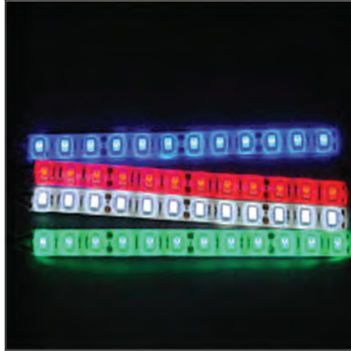
Gambar 3.37 LED dalam Bentuk Strip
