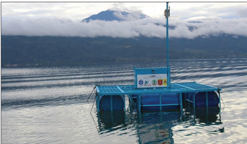
Gambar 6.12 Sistem Monitoring Online Parameter Kunci Terjadinya Kematian Massal Ikan di Danau Maninjau
