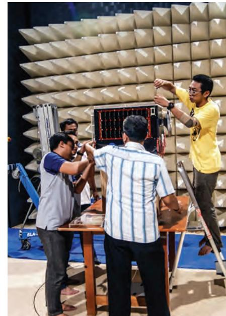
Penyiapan Unit Uji Satelit A3 LAPAN
