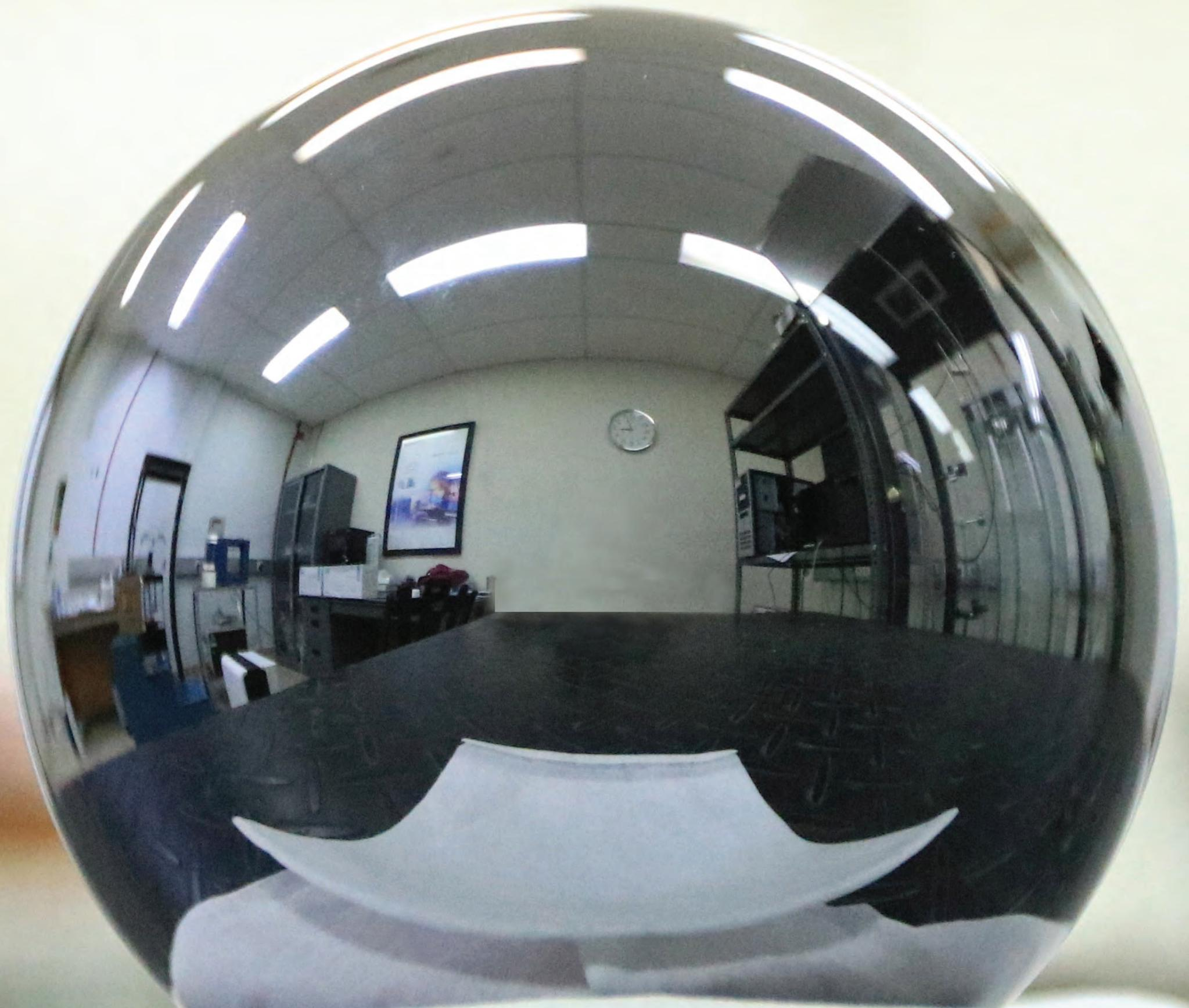
*Silicon Sphere*, Bola Silicon menjadi standar pengukuran internasional berdasarkan bilangan avogadro.
