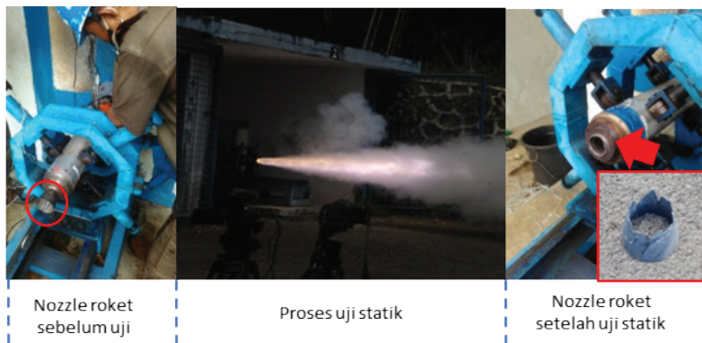
Gambar 8.2 Kegagalan yang terjadi pada divergent nosel roket saat uji static .
