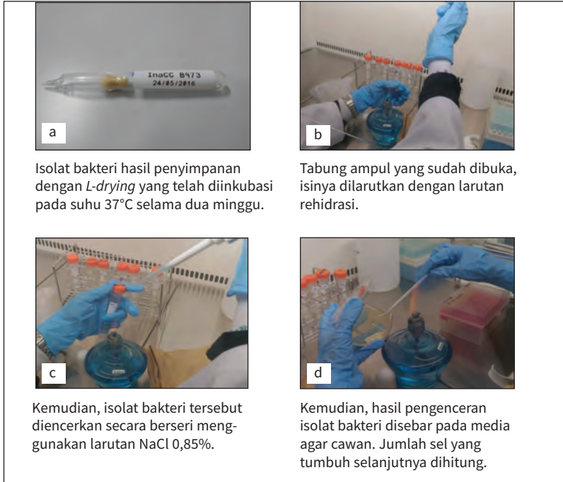
Gambar 4.1 Prosedur Metode ART pada Isolat Bakteri yang Disimpan dengan Cara L-drying
