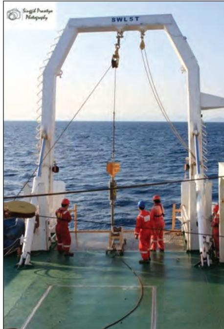
**Gambar 10.2** Proses Pengambilan Sampel dengan *Gravity Core*
