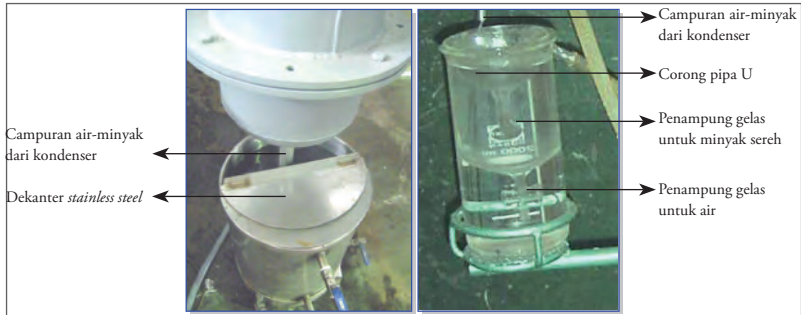
Gambar 3.8 Alat Pemisah Minyak Serai Wangi dan Air (Dekanter) Berbahan Stainless Steel (A) dan Berbahan Kaca (B)
