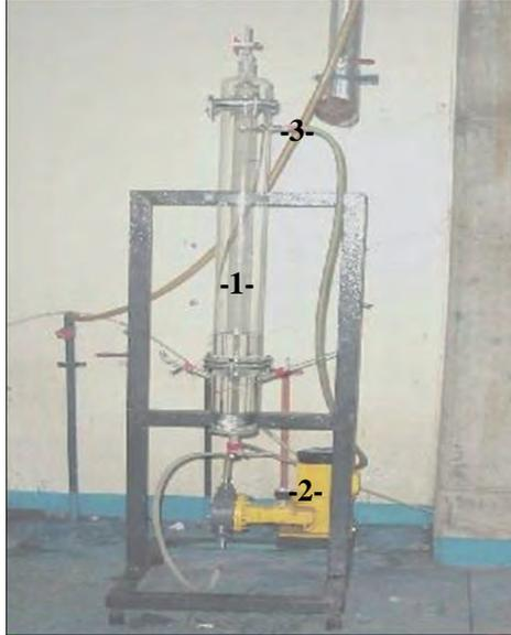
Ket.: 1) Tabung Gelas Perkolator (Bahan); 2) Pompa Dorong Pelarut; 3) Kondensor
