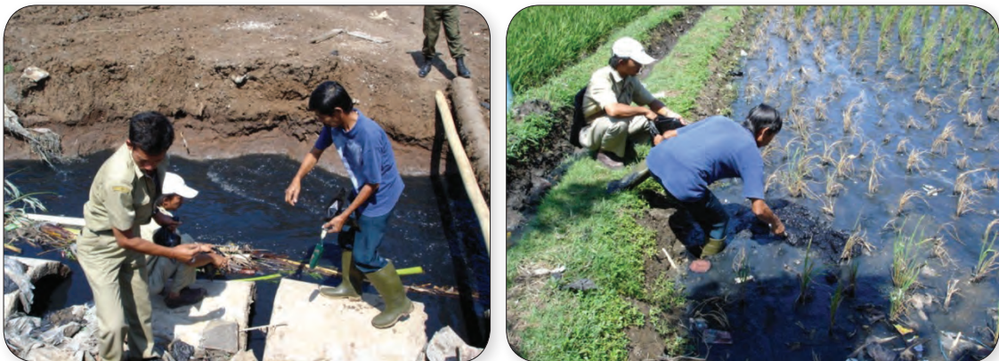
Gambar 121. Limbah buangan pabrik tekstil yang masuk saluran irigasi persawahan (A), sampling tanah sawah tercemar logam berat limpasan limbah (B)
