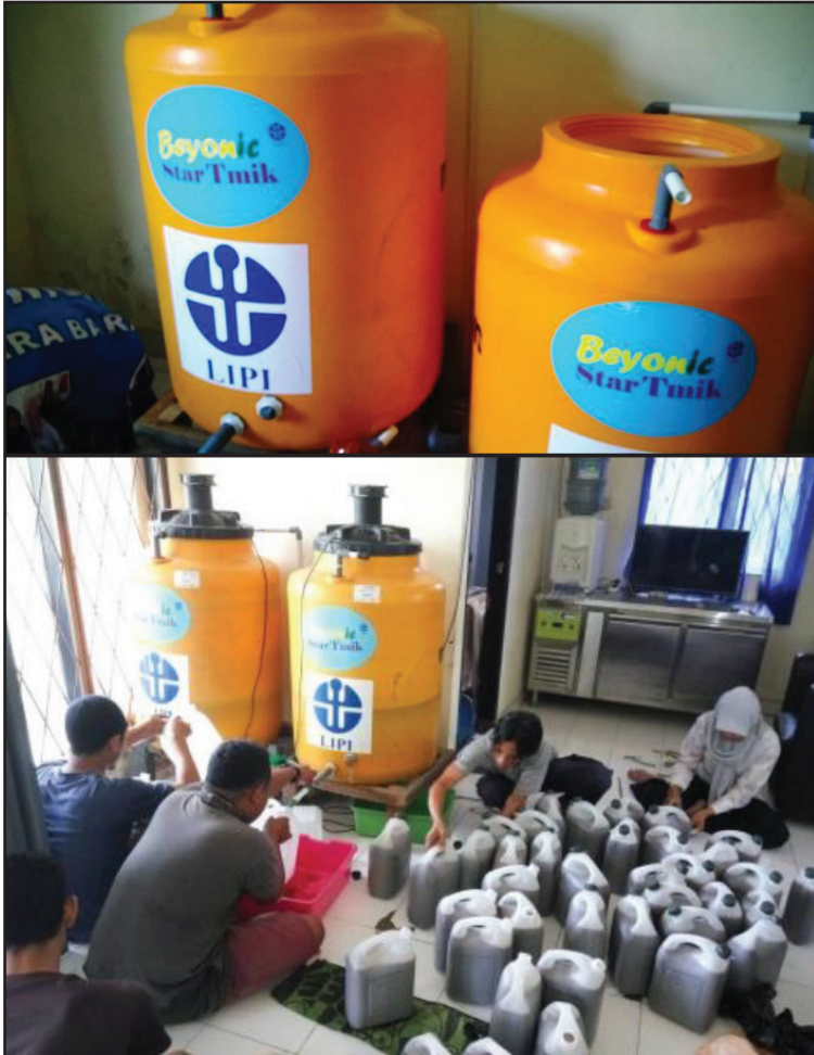
Gambar 4. Alat Fermentor Lokal untuk Produksi POH di Technopark Banyumulek
