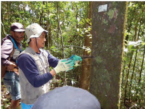
Pengambilan sampel kayu dengan bor riap ( increment borer )
