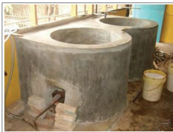
Gambar 1.2 Tungku pemasakan dibuat dari tembok dengan dasar dari wajan logam.
