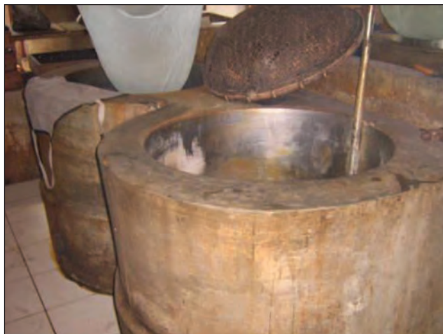
Gambar 3.4 Bak Pemasakan pada IKM Tahu KAGUMA Sayegan, Sleman
