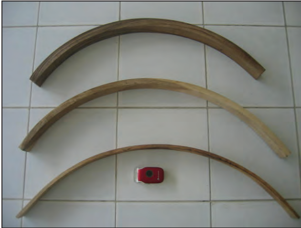
Gambar 3. Kayu Lengkung dengan Ketebalan 10, 20, 30 mm
