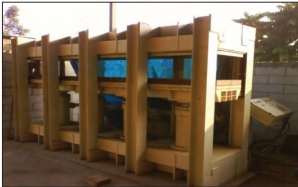
Gambar 2. Alat Pres Skala Pemakaian dengan Metode CSC
