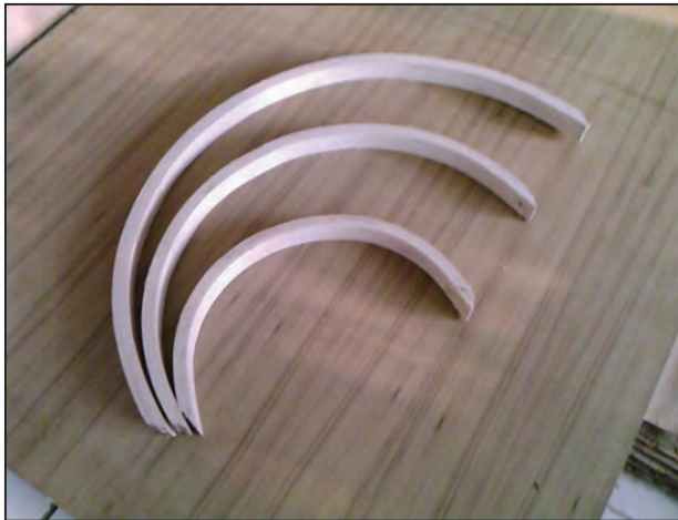
Gambar 4. LVL Lengkung dengan Berbagai Radius Lengkung
