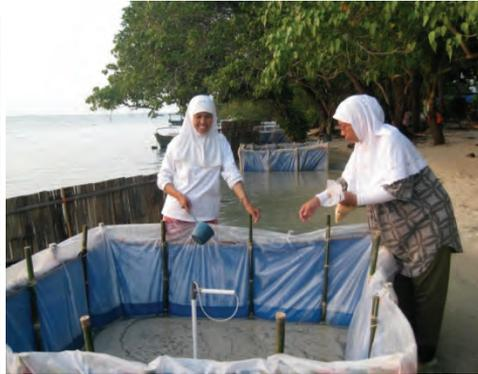
**Gambar 82.** Pengujian aplikasi teknik bioremediasi menggunakan bakteri dan pupuk di pantai berpasir Pulau Pari, Kepulauan Seribu, tahun 2009.
