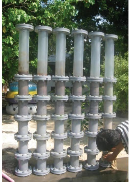
**Gambar 81.** Mesokosm dengan menggunakan kolom pasir yang ditanam di sumur beton di selatan Pulau Pari, Kepulauan Seribu, selama tiga bulan.
