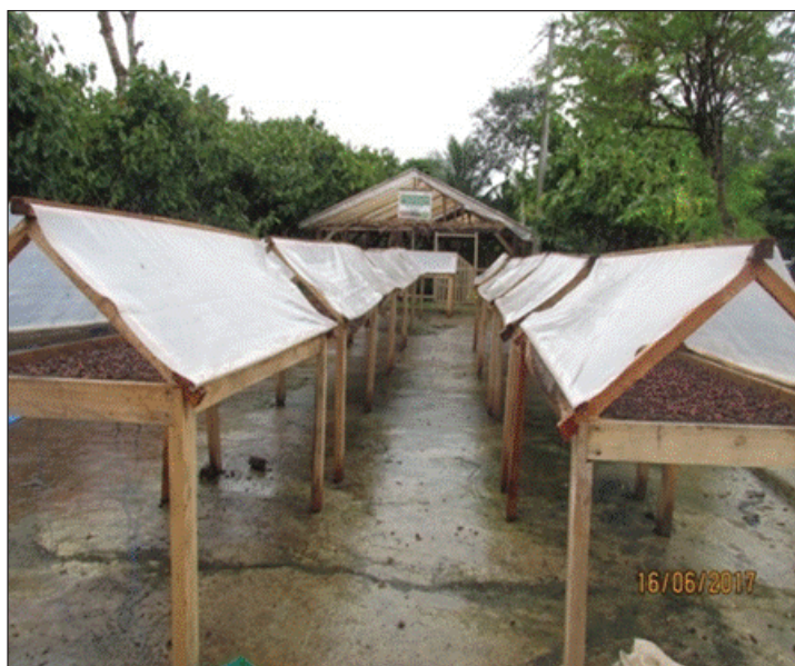
Gambar 18. Proses pengeringan menggunakan solar dryer sederhana
