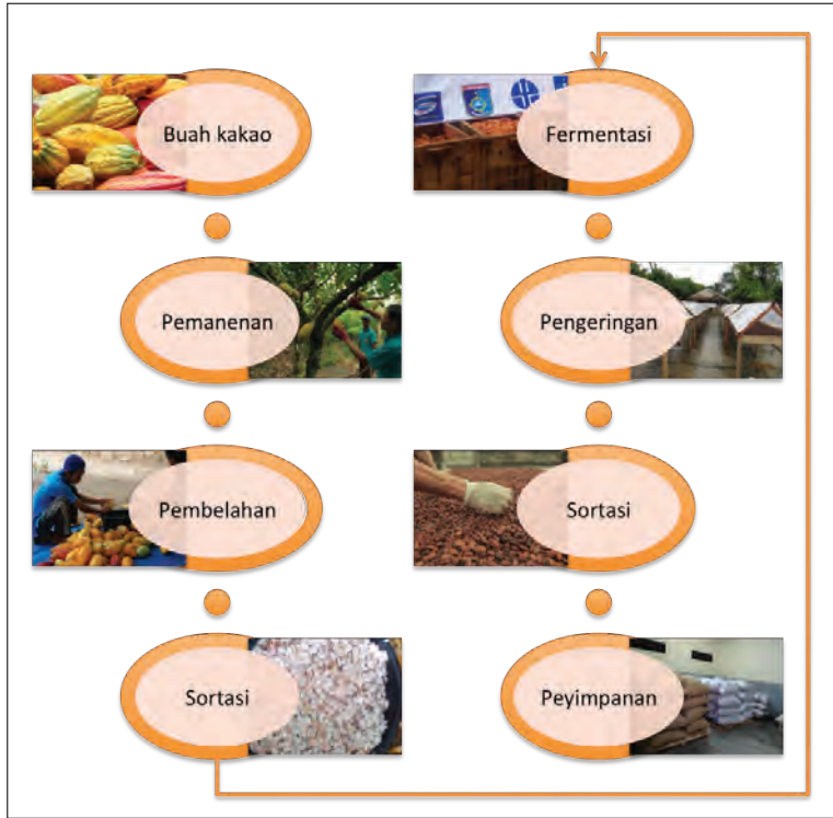
Gambar 7. Alur proses pengolahan primer buah kakao menjadi biji kakao kering terfermentasi.
