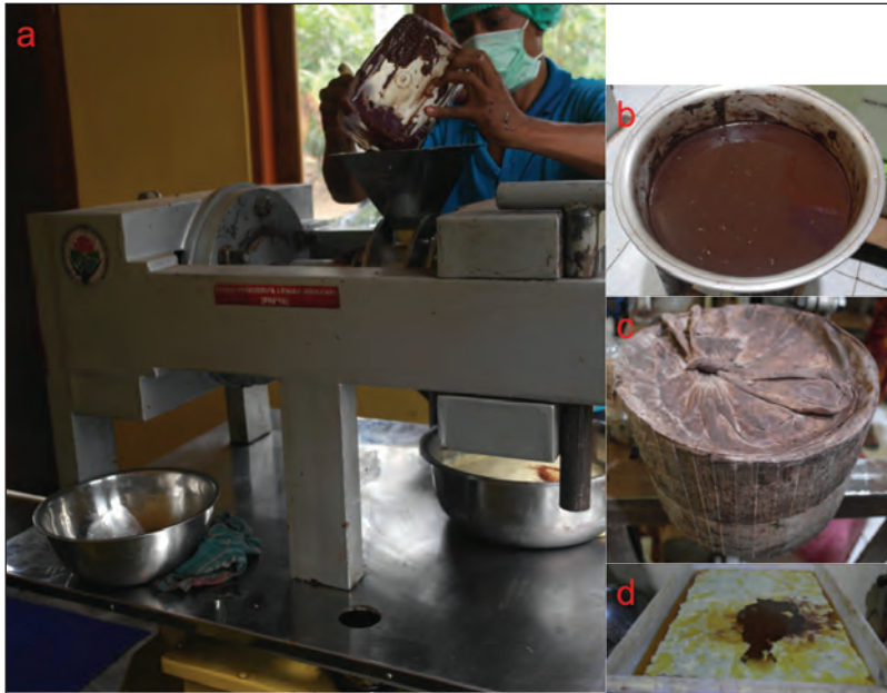
Keterangan: A) Mesin pengepres, B) Pasta, C) Bungkil, D) Lemak Sumber: Fahrurrozi (2019)
