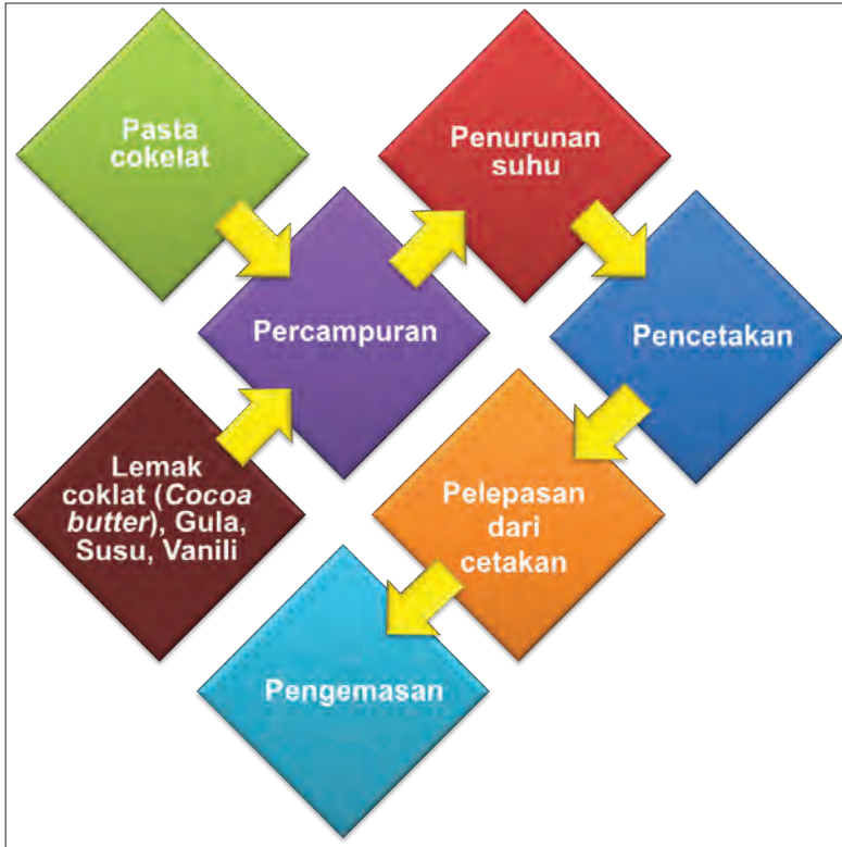
Gambar 27. Alur Proses Pembuatan Cokelat Bar
