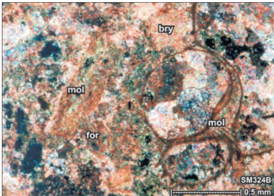
Gambar 7.39 Batugamping bioklastika grainstone (kode sampel SM324B, lihat Gambar 7.30) dengan beragam bioklastika pada semen karbonat, mencirikan SMF12-FZ6 pada daerah tepi lerengan atau landaian.
