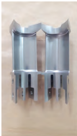
Gambar 8. Prototipe sudu turbin uap dari baja tahan karat martensitik 410 modifikasi (13Cr3Mo3Ni).
