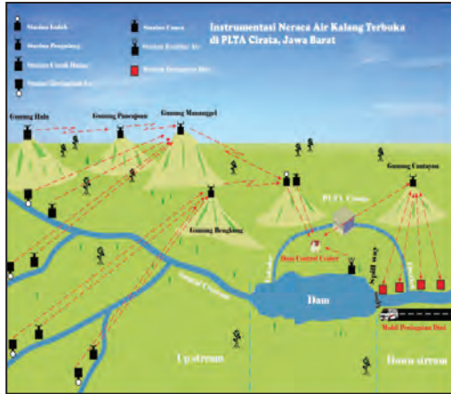
Gambar 3. Instrumentasi neraca air kalang terbuka dalam bentuk yang disederhanakan yang dibangun untuk PLTA Cirata mulai tahun 1987 55 .
