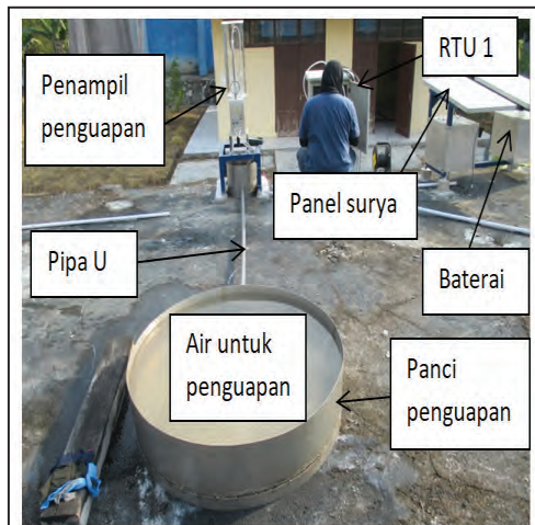
Lampiran 3. Instrumen Evaporasi Beserta Panel Surya dan Media Komunikasi Data Lokal 11
