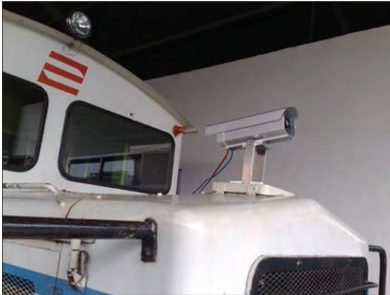
**Gambar 28.** Penempatan Kamera pada Pengukuran Jarak Jauh pada Lori di Stasiun Bandung
