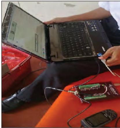
**Gambar 25.** Instrumen Pengukur Vibrasi Perjalanan Kereta Api
