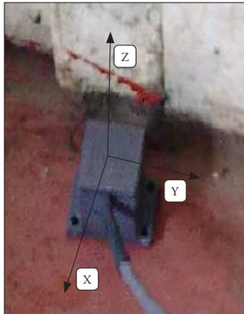
**Gambar 24.** Ilustrasi Penempatan Akselerometer pada Sumbu Z
