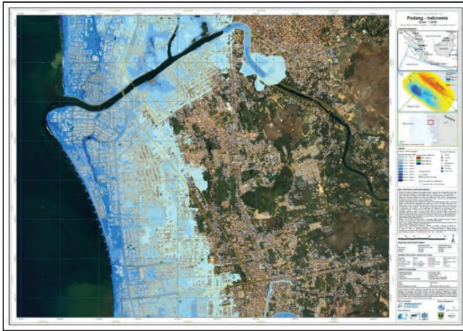
Gambar 30. Peta Bahaya Genangan Tsunami untuk Kota Padang yang Dibuat oleh The Last Mile Project Indonesia-Jerman Berdasarkan Kesepakatan Padang Protokol Tahun 2008
