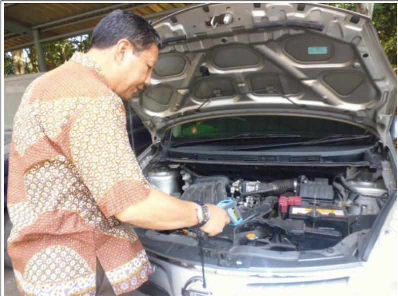
**Gambar 1.7** Penggunaan Termometer Inframerah pada Pemeliharaan dan Perbaikan Mesin Mobil
