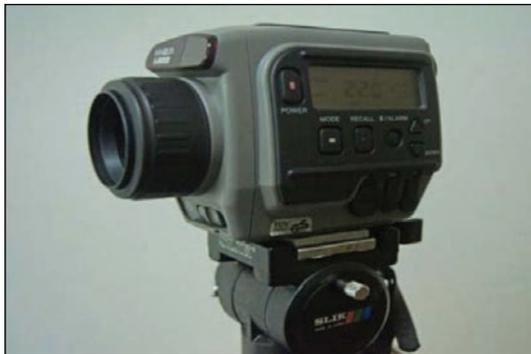
**Gambar 3.1** Termometer Inframerah Jenis Kamera
