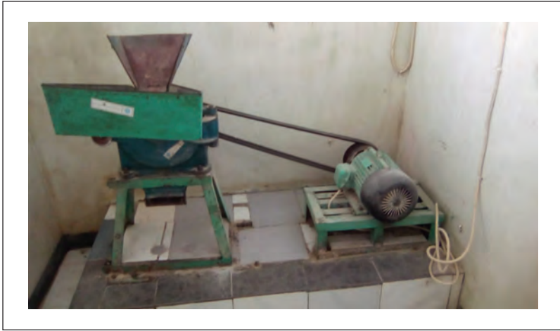
Gambar 2.2 Contoh Mesin Penggiling untuk Proses Mocaf
