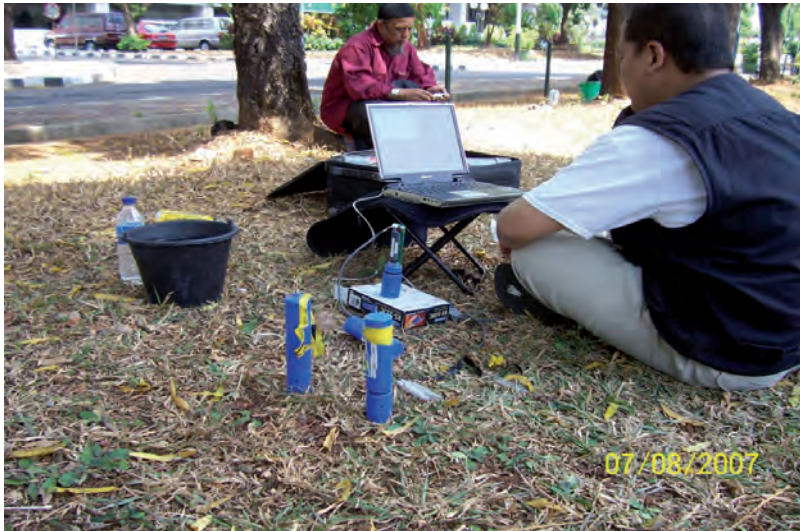
Gambar 4.11 Beberapa Sensor yang Dipasang pada Lima Sumur Pantau di Sekitar Cekungan Jakarta
