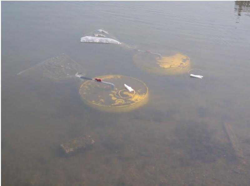
Gambar 7.3 Seepage Meter yang Terpasang di Pantai Karnaval, Ancol
