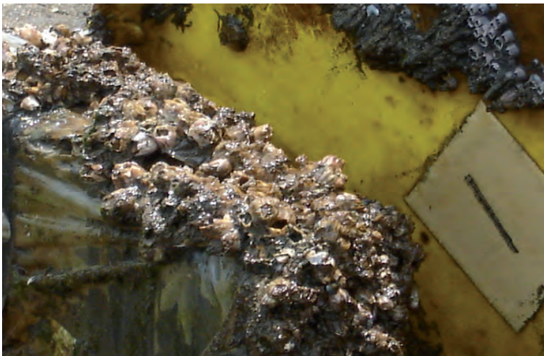
Gambar 7.11 Teritip ( Amphibalanus amphitrite ) yang Melekat pada Seepage Meter pada Juni 2009
