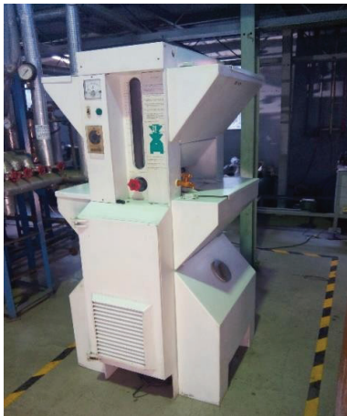
Gambar 8. Unit Pembangkit Setempat Hipokhlorit
