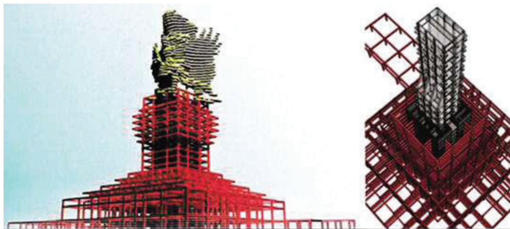
Gambar 1. Struktur Utama Patung dan Pedestal GWK.
