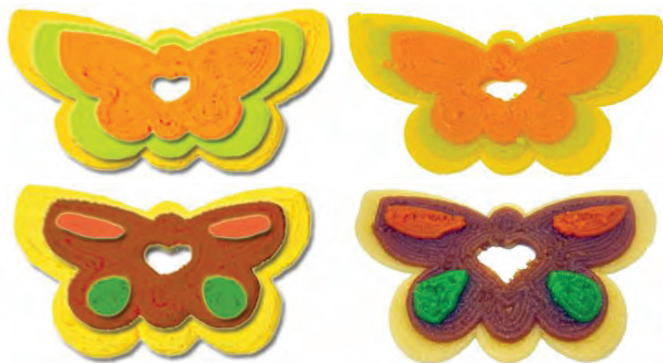
Gambar 12.4 Desain Makanan Multibahan (atas) dan Sampel Fabrikasi (bawah)
