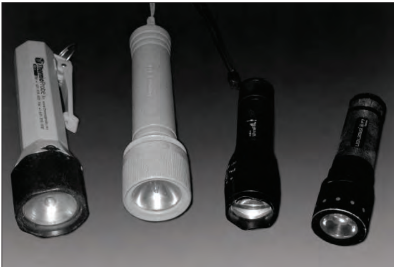
Gambar 3.12 Beberapa macam alat penerangan listrik kedap air yang tidak menyebabkan banyak gangguan magnetis.
