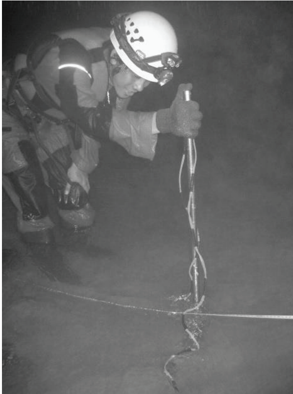
Gambar 13.6 Mengukur Kecepatan Arus Menggunakan Current Meter
