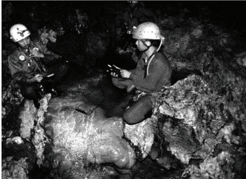
Gambar 13.7 Mengukur Debit Air Sungai Bawah Tanah dengan Alat EC Meter
