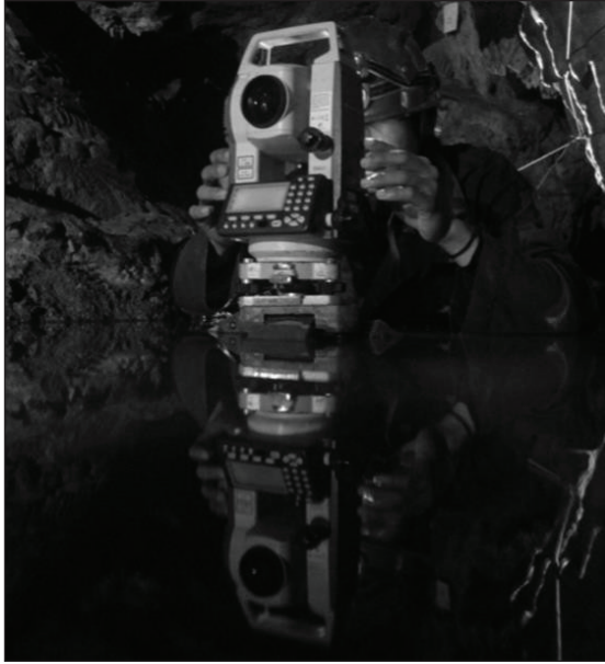
Gambar 12.9 Survei pada lorong berair dan beratap rendah menggunakan alat Total Station Sokkia SET 350X
