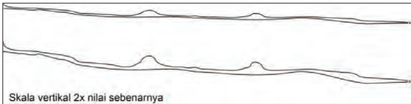
Gambar 7.14 Peta tampak samping dengan satu besaran skala (atas) dan peta dengan skala vertikal yang diperbesar dua kali dari skala horizontal (bawah).
