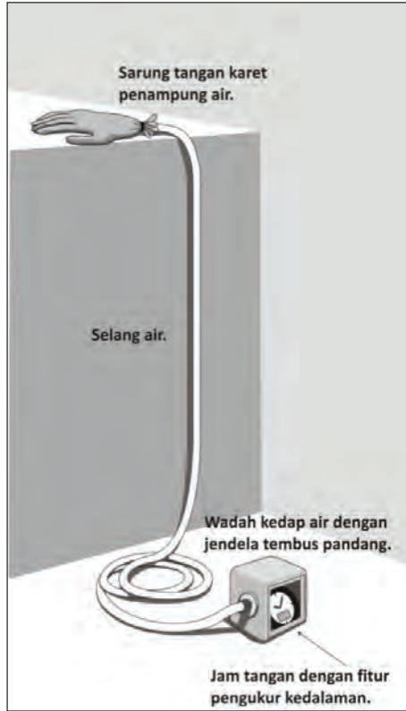
Gambar 4.13 Skema Pengukuran Beda Tinggi dengan Metode Hydrolevelling
