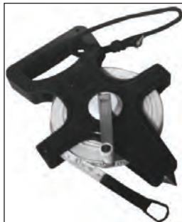
Gambar 3.7 Pita Ukur Fiber dengan Casing Terbuka
