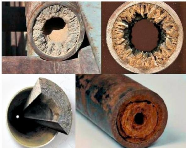
**Gambar 2.6 Kerak *TENORM* pada pipa-pipa di industri migas [13]**
