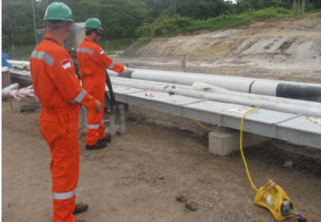
**Gambar 1.2 Persiapan kegiatan radiografi industri dengan zat radioaktif**
