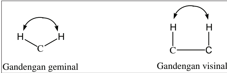
Gambar 28. Ilustrasi Korelasi Proton-proton Geminal dan Visinal dalam Teknik DQF-COSY atau DQ-COSY
