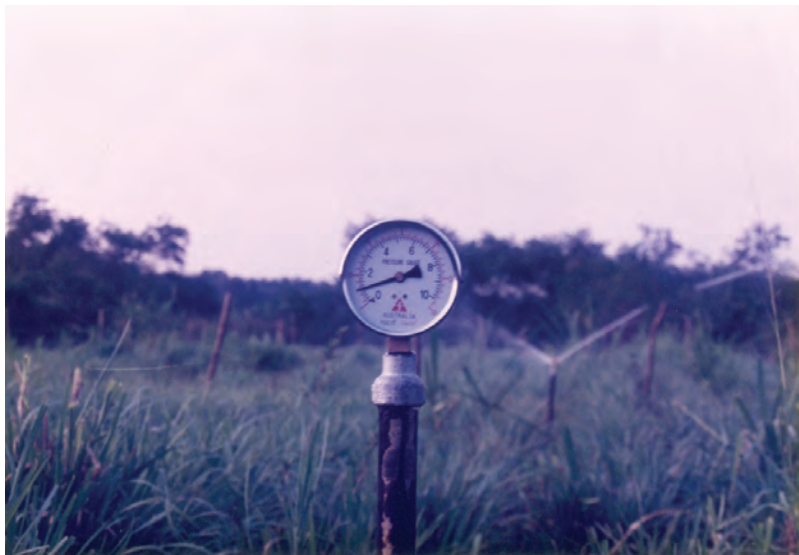
Gambar 8. Pressure Gauge pada Nozel Sprinkler 1,0 Bar
