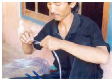
Gambar 33. Batang Kawat Seng Sepanjang 5 cm Dimasukkan ke Dalam Ulir Plastik Sedalam Setengah Bagaiannya
