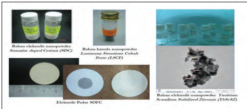
Gambar 4. Elektrolit dan Elektroda SOFC Berbasis LTJ 13,38
