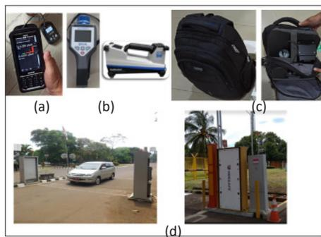
Keterangan: (a) PRD, (b) RID, (c) BRD, dan (d) RPM
