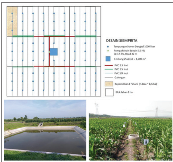
Gambar 6.13 Sistem Irigasi Embung Terkoneksi Tangkapan Renteng Hemat Air
